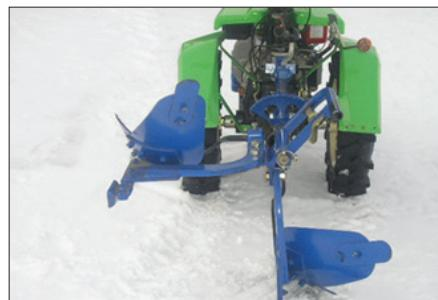
Slika 5. Obrtni plug za jednoosovinske traktore
